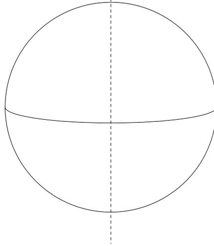
Placer 2 points sur le cercle, à "hauteur" du centre du cercle, tracer la partie visible, donc en trait plein, de l'équateur en prenant les 2 points placés comme extrémité de l'équateur.
